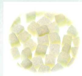
PU擔體(BioNET)：有效表面積大、微生物高活性、容易流動、多孔結構促進脫氮
